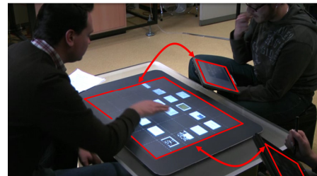
Abbildung 8: Wanddisplay als „Todo“-Liste (oben). Tablet-PCs dienen als persönliche Arbeitsbereiche um einen Tabletop (unten).
