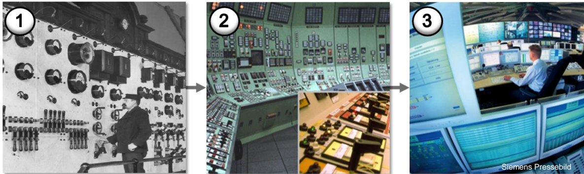
Bild 1: Interaktionsparadigmen der Prozesssteuerung: (1) Dezentrale Prozesssteuerung; (2) zentrale, manuelle Prozesssteuerung; (3) zentrale, digitale Prozesssteuerung. [10]
