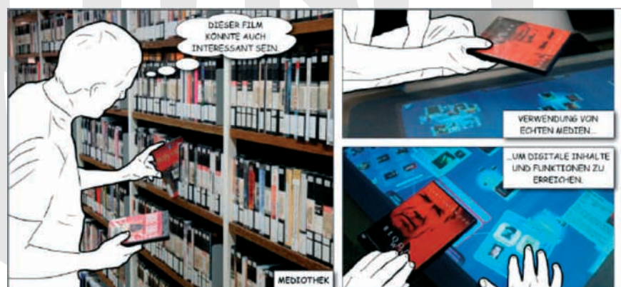
Bild 7: DVDs aus den Regalen der Bibliothek werden in die Interaktion mit einbezogen. Eine DVD wird auf einen Multitouch-Tisch gelegt und erkannt. Anschließend werden um die DVD herum interaktive Schaltflächen mit Informationen und Funktionen angezeigt, um z. B. ähnliche Medien zu finden.
