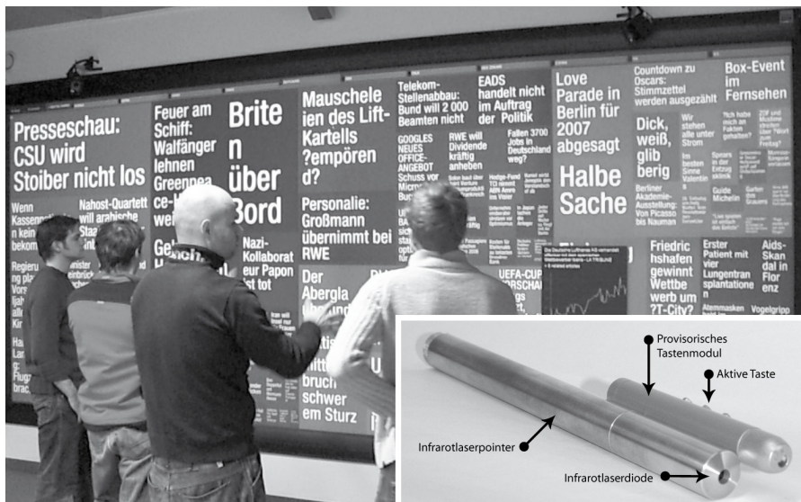
Abbildung 1: Newsmap-Visualisierung auf der Konstanzer Powerwall und evaluierter Infrarotlaserpointer
