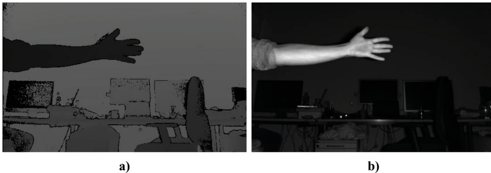
Abbildung 12: Der Tiefen- (a) und Infrarot-Stream (b) in Argus Control. Der Tiefen-Stream stellt die Tiefe des Raums in Graustufen dar. Der Infrarot-Stream liefert ein realitätsgetreues Bild des Raums.
