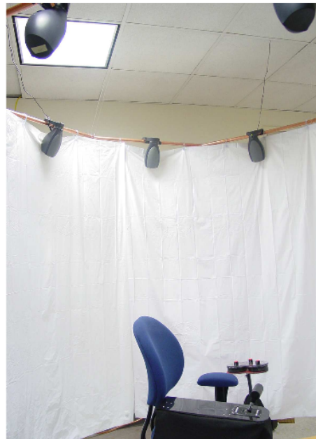
Abbildung 6: Der drehbare Bürostuhl ist von Lautsprechern umgeben und mit zusätzlichen Hebeln und Knöpfen ausgestattet ((Polastre et al., 2002), p. 2 figure 4).
