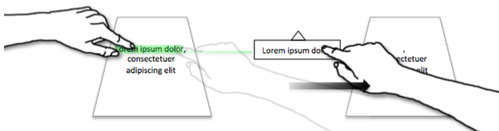
Abbildung 31: Um einen Textabschnitt zu kopieren wird mit Hilfe der NDH aus dem Bewegungsmodus in den Kopiermodus gewechselt.
