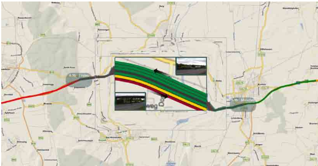
Abb. 4.4: Focus+Context: Ein Fisheye-Interface zur Visualisierung von Prozessvariablen [SBMR11]
