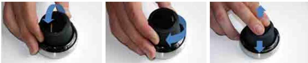
Abb. 4.13: Funktionen des SpaceNavigators: (links) Kippen; (Mitte) Drehen; (rechts) Drücken/Ziehen
