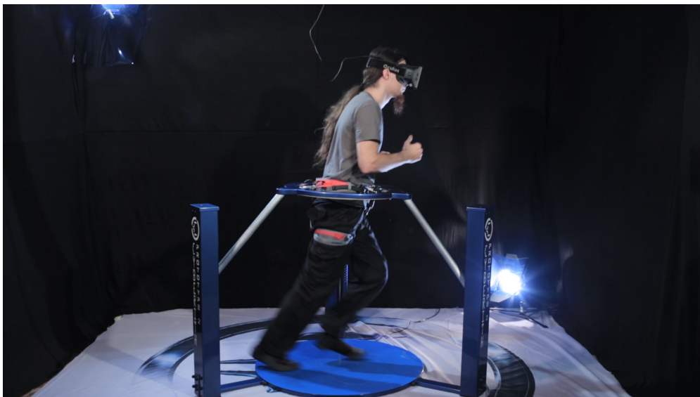
Abbildung 3: Ein Spieler bewegt sich auf einem omni-direktionalen Laufband, um einen Charakter in einem Spiel zu steuern. Quelle: Siehe Fußnote 1
