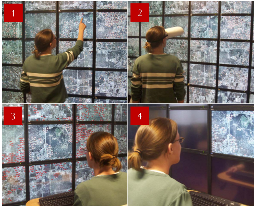
Abbildung 7: Die vier verschiedenen Versuchsbedingungen: 50 Monitore, Bewegung und Sicht uneingeschränkt (1); 50 Monitore, Bewegung uneingeschränkt, Sicht eingeschränkt (2); 25 Monitore, Bewegung eingeschränkt, Sicht uneingeschränkt (3); 1 Monitor, Bewegung eingeschränkt, Sicht eingeschränkt (4). [2]
