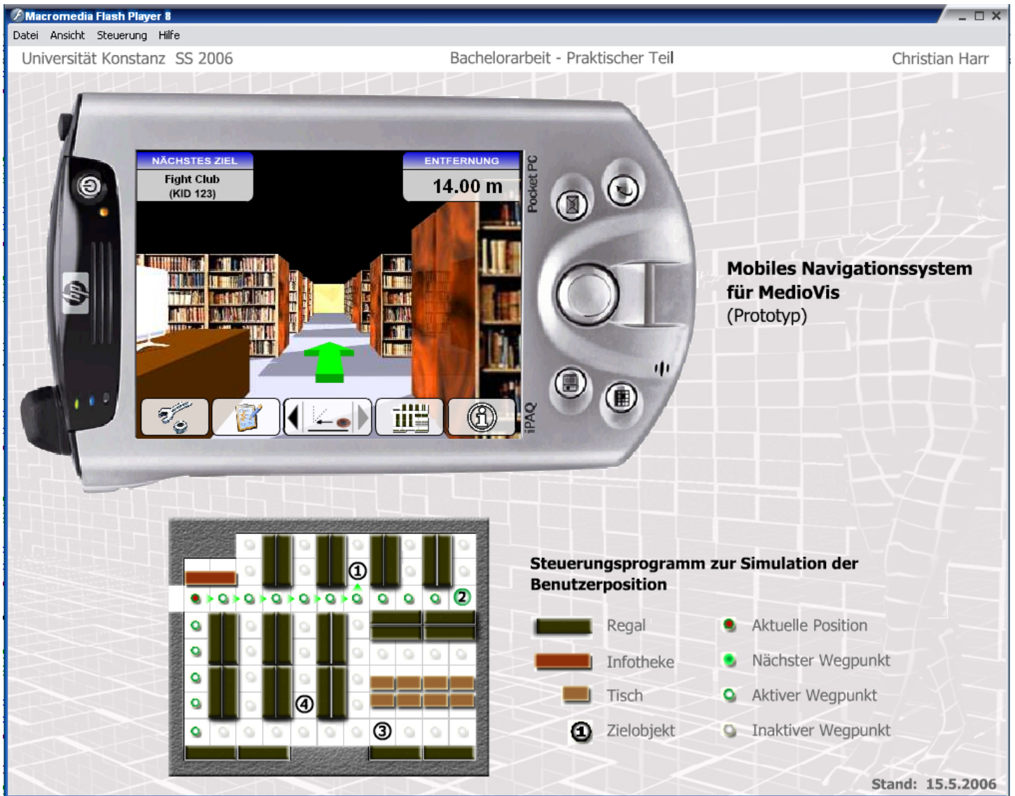
Abbildung 36: Kompletter Prototyp. (oben) Navigationssystem, (unten) Steuerungsprogramm.
