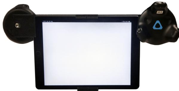
**Abbildung 2.3.:** Zwei Vive Tracker sind über einen extra angefertigten Rahmen an das Tablet angebracht. Mit diesen soll die Position des Tablets im Raum getrackt werden. *Übernommen von [10]*
