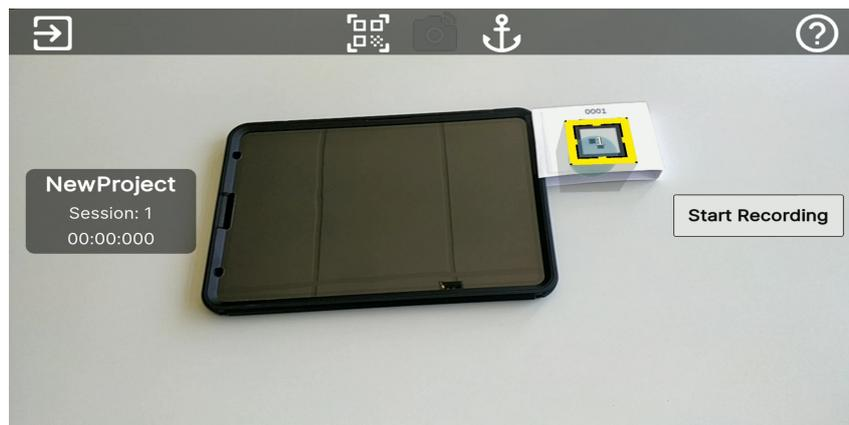
**Abbildung 4.9.:** Ein Tablet, das mit Markern zum Tracking Target gemacht wurde. Außer der Vorder- und Rückseite sind die Seiten zu schmal um Marker daran anzubringen. *Übernommen aus [4]*
