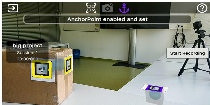
**Abbildung 4.11.:** Der Ankerpunkt Marker mit der ID 0 hat einen violetten Indikator um ihn unterscheiden zu können. Beim setzen, verschieben und entfernen des Ankerpunkts erhält der Nutzer Feedback in Form einer Benachrichtigung auf dem Bildschirm. *Übernommen von [4]*
