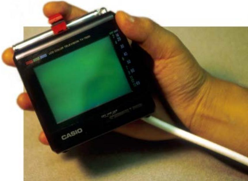
*Abbildung 4: Chameleon - Display mit Trackingsystem und Schalter*
