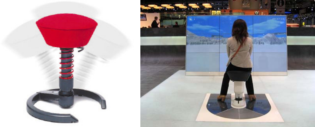
Abbildung 3.2: Links: ChairIO, ChairBased 3D Interface. Rechts: ChairIO Demonstration im Rahmen des Genfer Automobil-Salons 2006 [BBH05].
