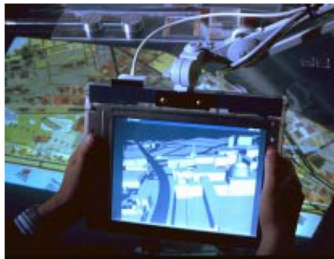
Abbildung 20: „Active Lens“ über dem Tabletop, um eine dreidimensionale Darstellung der Gebäude auf der dahinterliegenden Karte zu erhalten [Ullmer and Ishii 1997].
