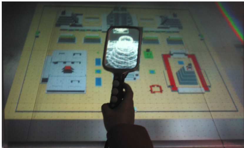
Abbildung 5.12: Das Prinzip der magic lense veranschaulicht an der „realen“ handheld magic lens des 3D Visualization and Imaging System Lab an der University of Arizona. Quelle: University of Arizona
