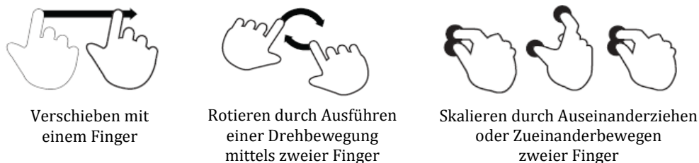
Abbildung 5.4: Von der Anwendung unterstützte (Multi-) Touch-Gesten (adaptiert von Villamor et al. , 2010)
