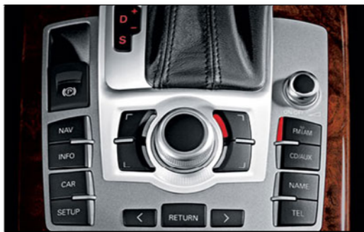
Abbildung 4.03: Das MMI-Terminal als Eingabegerät für das Audi MMI-System (Quelle: [Technofile 08]).
