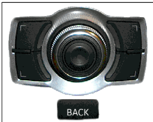
Abbildung 4.12: Altes MMI-Terminal mit Joystick zur Mauszeigersteuerung.
