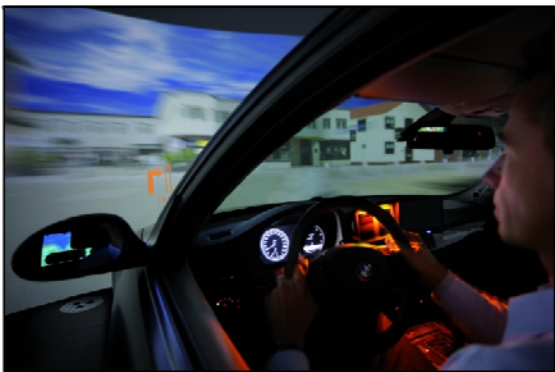
Abbildung 3.07: Hi-Fi Fahrsimulator mit 360°-Ansicht. Blick durch die Frontscheibe (Quelle: [MT 08]).
