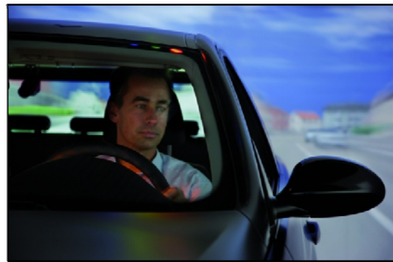
Abbildung 3.08: Hi-Fi Fahrsimulator mit 360°-Ansicht und Rückspiegel (Quelle: [MT 08]).
