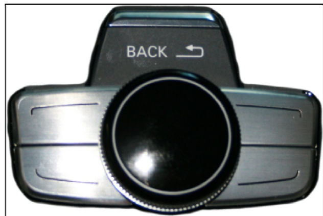
Abbildung 4.13: Neues MMI-Terminal mit Schiebemöglichkeit zur Mauszeigersteuerung.
