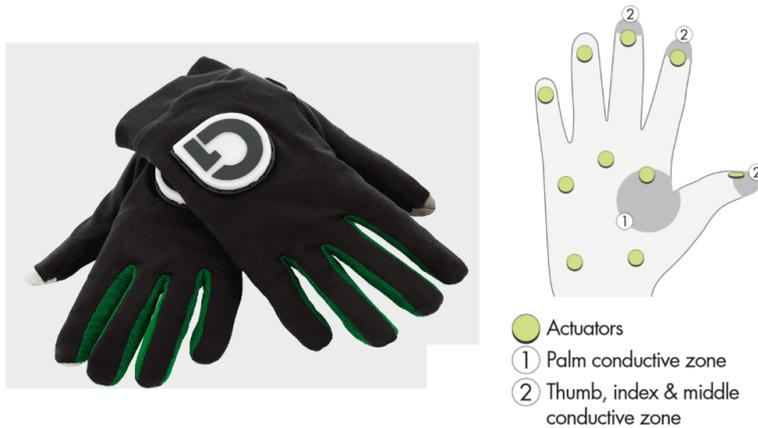
Abbildung 22: GloveOne Handschuhe und die Verteilung der Vibrationsmotoren [17]
