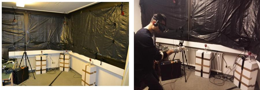
Abbildung 37: Teilnehmer standen während der Studie neben dem Tisch, mit dem Gesicht gerichtet zu den OptiTrack Kameras. Der schwarze Strich am Boden gab die Blickrichtung vor. Auf dem rechten Bild ist ein Teilnehmer während des Experiments zu sehen. Sein Arm wird von sechs OptiTrack Kameras getrackt.
