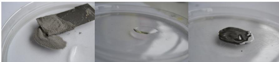
Abbildung 25: Auf dem rechten Bild sieht man die magnetorheologische Flüssigkeit - eine Mischung aus Eisenpulver (links) und pflanzlichem Öl (mitte).
