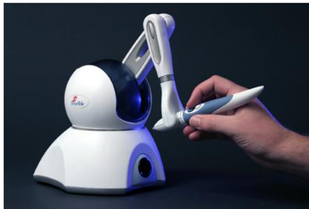
Abbildung 10: Der Force-Feedback Arm Geomagic Touch (früher Sensable Phantom Omni) [59]
