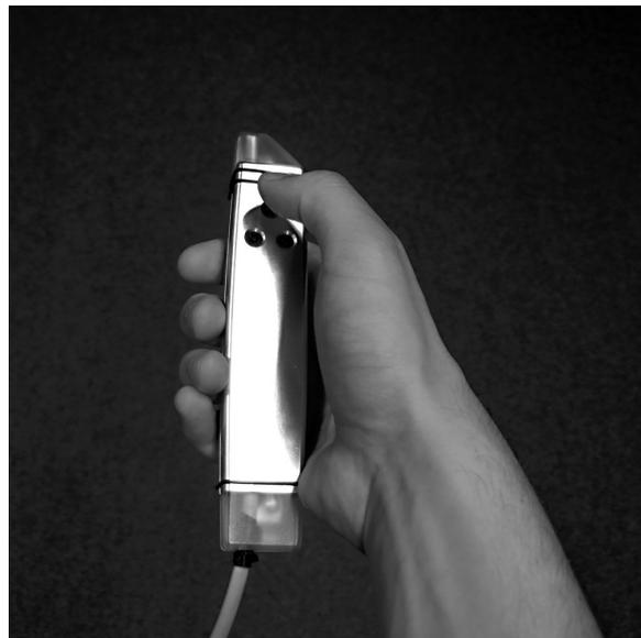
**Abbildung II-1: Das verwendete Laserpointer-Eingabegerät der Forschungsgruppe Mensch-Computer-Interaktion an der Universität Konstanz.**
