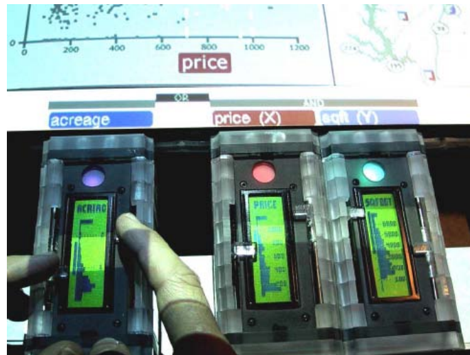
Abbildung 8: „Parameter Bar“ Token zur Eingrenzung eines Bereichs und der darin enthaltenen Menge an Datenpunkten innerhalb einer Scatterplot-Visualisierung [UHJ05].
