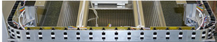
Abbildung 13: Der Rahmen mit den Distanzsensoren [Quelle: [14]]
